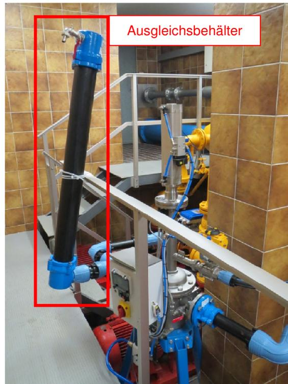
Abbildung 30: Versuchsaufbau - Optifil im Bypass mit Ausgleichsbehälter
