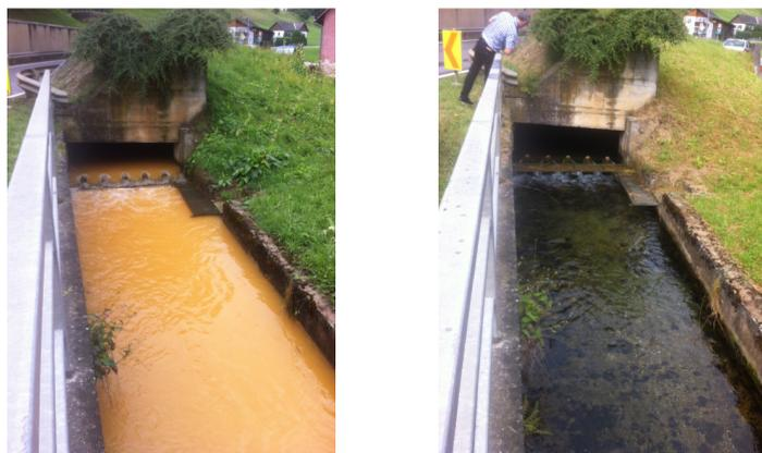
Abbildung 22: Überlauf der Baumühlquelle, Trübung über 190 NTU (li) und Trübung ca. 1,5 NTU (re)
