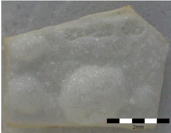
(a) Blasenbildung an der Probenoberfläche bei Temperaturen über 1200°C
