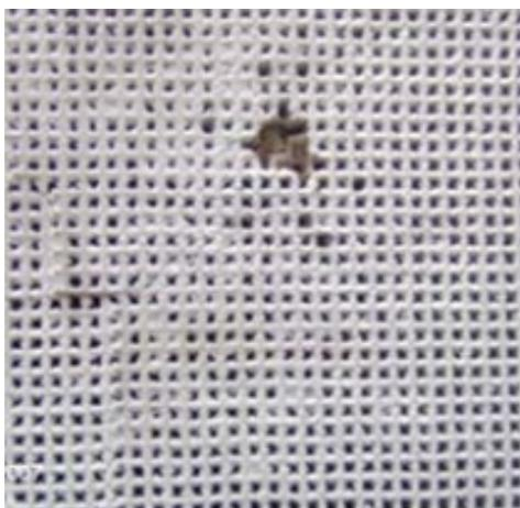
(a) SiO<sub>2</sub>-Ablagerungen an einem Wärmespeichermonolithen [7]
