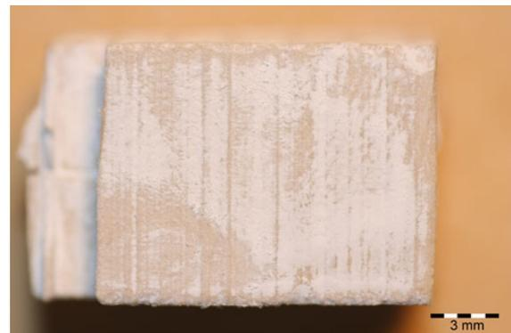
(d) Seitenfläche MK20 Keramik einmalig mit Ekamold Spray beschichtet
