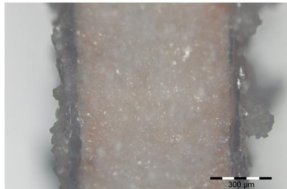
(b) Querschliff eines Strömungskanals, Probe Megtec
