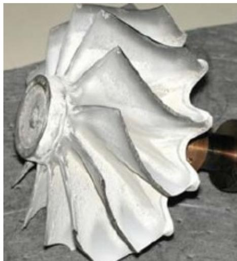
(b) SiO<sub>2</sub>-Ablagerungen an Turbinenschaufeln [16]
