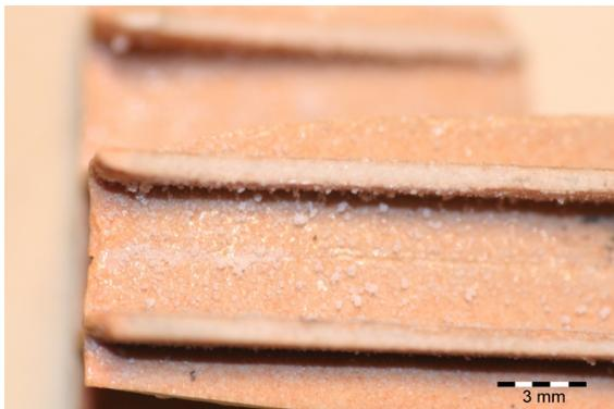
(a) Partikelförmige SiO<sub>2</sub>-Ablagerungen auf der NT Basiskeramik
