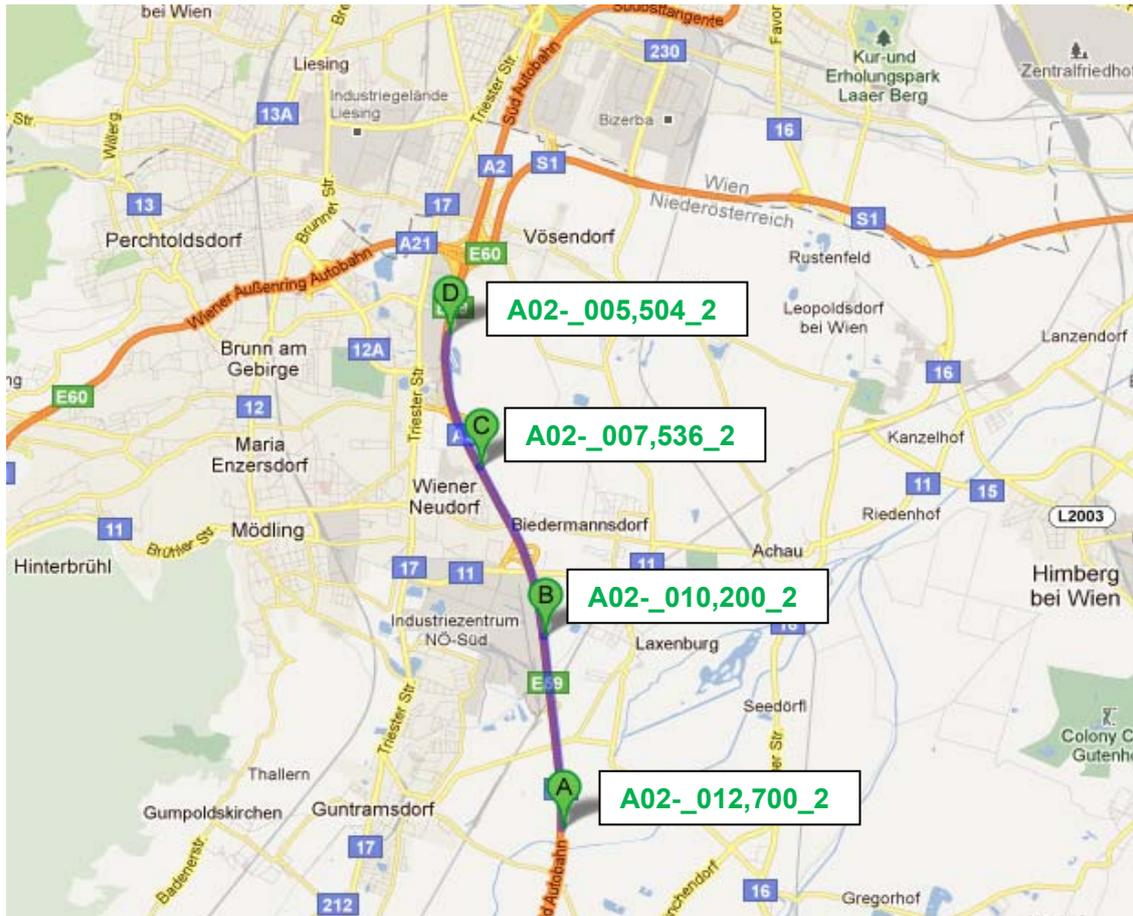
**Abbildung 4-15: Streckenabschnitt der Probefahrt, Testfeld A02\_2, 4 Fahrstreifen, zulässige Höchstgeschwindigkeiten von 80 km/h bzw. 100 km/h (KFZ>3,57) und 130 km/h (KFZ<3,5), Freitag 09.09.2011**
