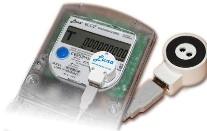
Abbildung 7.3.: Verwendung der optischen Schnittstelle und Lesegerät von unten
