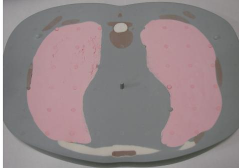
**Abbildung 6.8:** Querschnitt durch das Phantom Alain in Brusthöhe. Gut zu erkennen sind die Äquivalente zu Lungengewebe (rosa), Rippen (braun), Knorpel (hellgrau) und Knochenmark (weiß).
