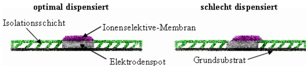
*Abbildung 11 – Dispensieren der Kalium- bzw. Ammoniummembran: Diese Abbildung zeigt schematisch die Position einer optimal dispensierten bzw. einer schlecht dispensierten ionenselektiven Membran auf dem Elektrodenspot. Quelle: Eigene Abbildung.*
