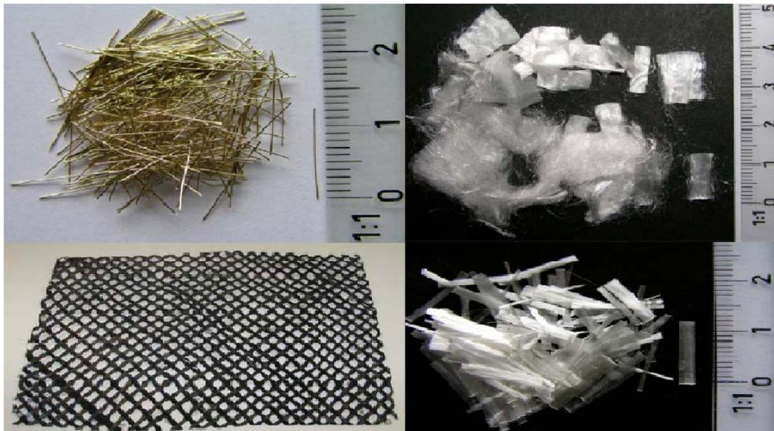
Abbildung 2: Verschiedene Faserarten: l.o. Stahlfasern, r.o. Polypropylen-Fasern, l.u. Kohlenstofffasergewebe, r.u. Glasfasern [5]
