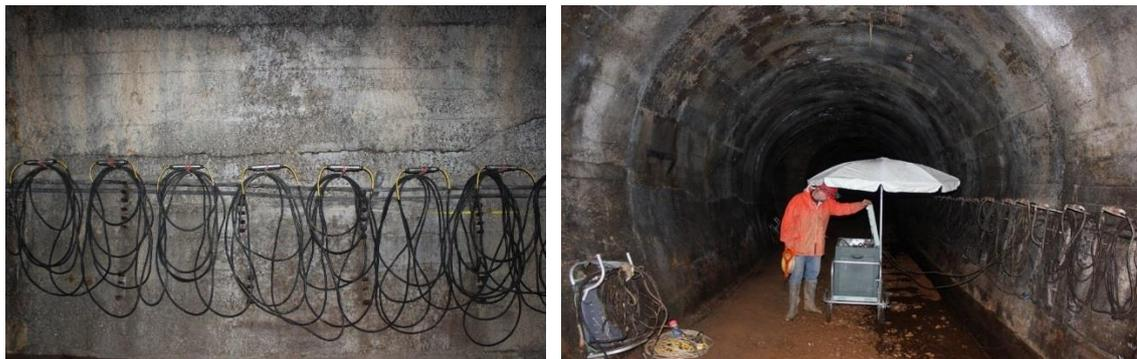
Abbildung 28: Messaufbau der Multielektrodengeoelektrik (links) und Messgerät mit Tropfwasserschutz (rechts)
