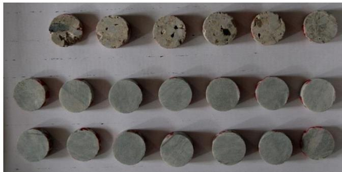
Abbildung 56: Proben des Bohrmaterials (Probenbeschriftung mit BL1.01A fortlaufend von links oben nach rechts unten)
