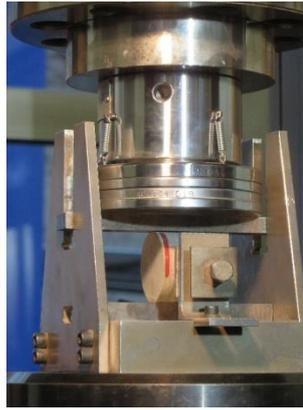
Abbildung 54: Spaltzugversuch
