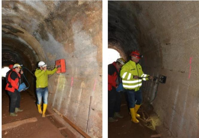
Abbildung 32: Georadarmmessung bei unterschiedlichen Mittenfrequenzen
