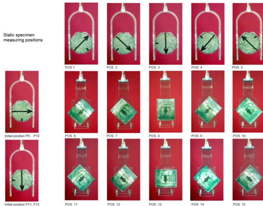
Abbildung 15: Manuelle Messung der Suszeptibilität in 15 Richtungen mit der Kappabridge MFK 1 von Agico Inc. (Advanced Geoscience Instruments Co., 2009)
