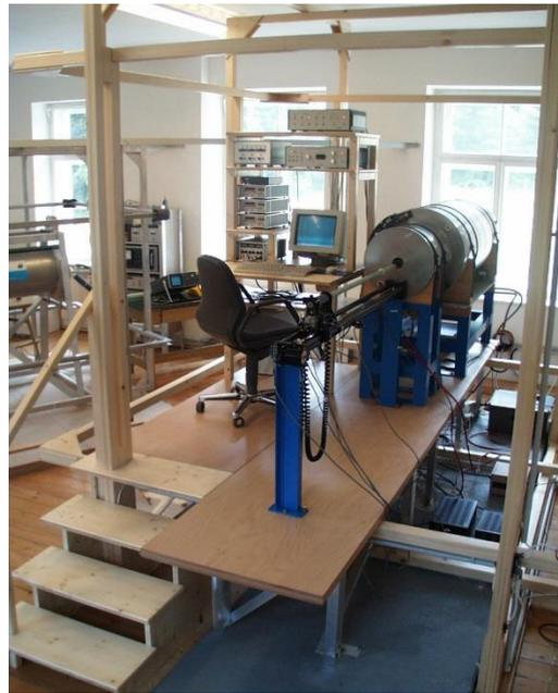
Abbildung 68: Cryogen-Magnetometer der Montanuniversität Leoben zur Bestimmung der NRM
