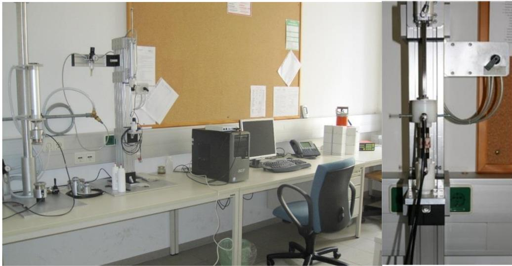
Abbildung 59: Ultraschallmessgerät der Montanuniversität Leoben
