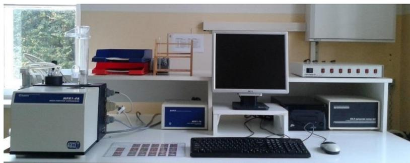
Abbildung 61: MFK1 Kappabridge, dient zur Messung der Suszeptibilität in 15 Richtungen und zur Curie-Punkt- Bestimmung
