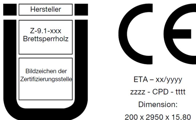
Abbildung 2.25: Beispiel eines ÜA-Zeichens und CE-Zeichens für ein zugelassenes Brettsperrholz<sup>137</sup>
