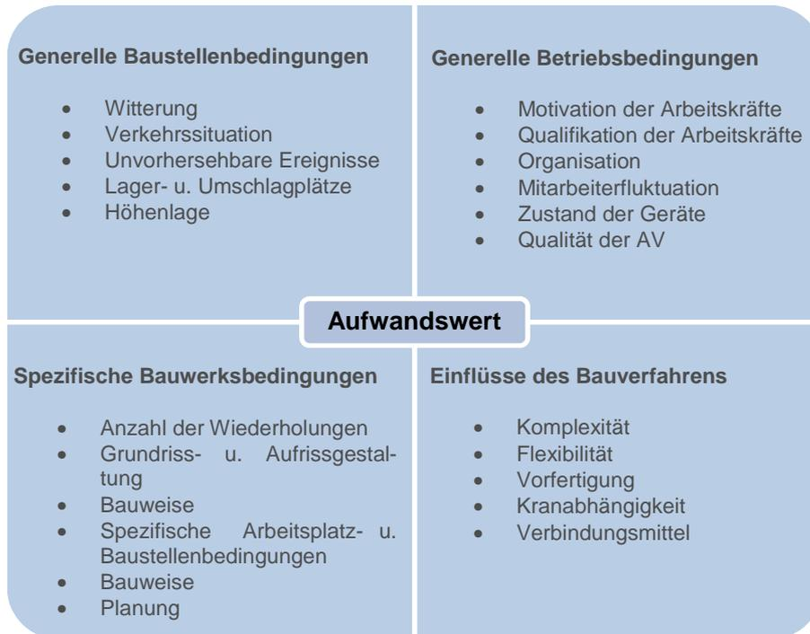
Abbildung 2.47: Einflussgrößen auf den Aufwandswert im Holzbau (in Anlehnung an Hofstadler)<sup>271</sup>
