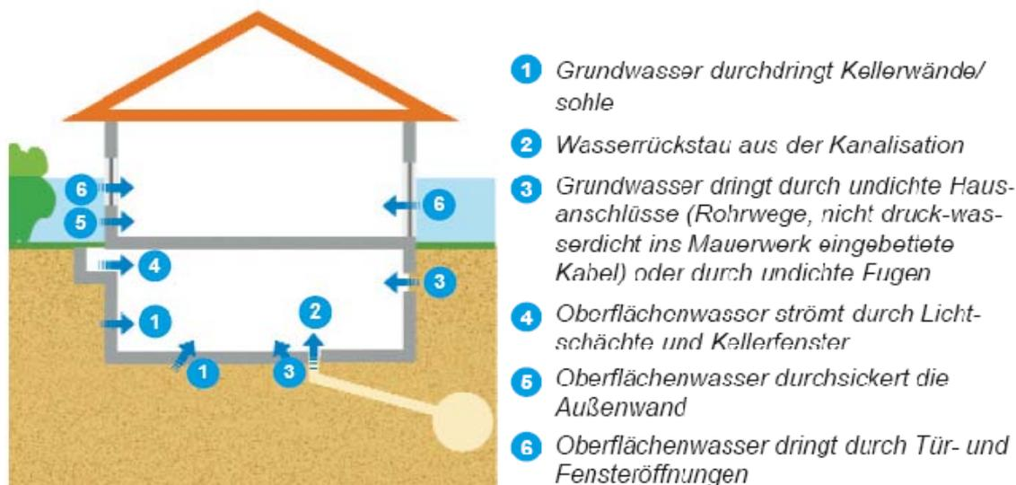
Abbildung 12: Wege des Wassers ins Gebäude (Brandstetter et al., 2010)
