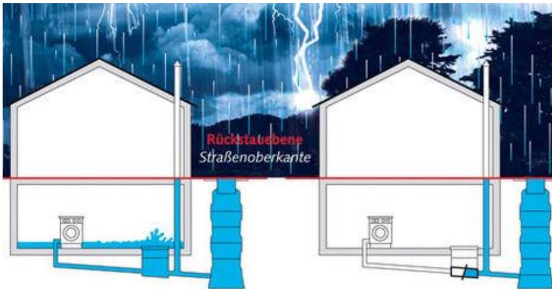
Abbildung 19: Gebäude ohne (linke Abbildung) und mit Einbau einer Rückstausicherung ([http://www.selbst.de/sites/default/files/imagecache/Headerbild/pictures/import/headerbild\\_bauidee/11439\\_9\\_485.jpg](http://www.selbst.de/sites/default/files/imagecache/Headerbild/pictures/import/headerbild_bauidee/11439_9_485.jpg))
