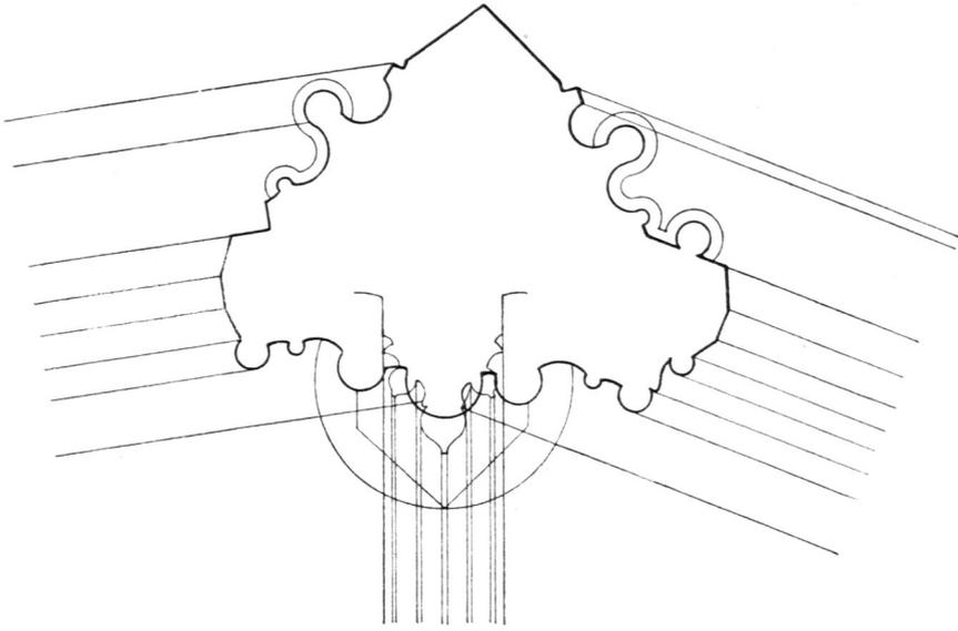
Grundriß eines Pfeilers in der Höhe der Hochschiffsfenster im Chor des Domes zu Cöln<sup>19)</sup>.
