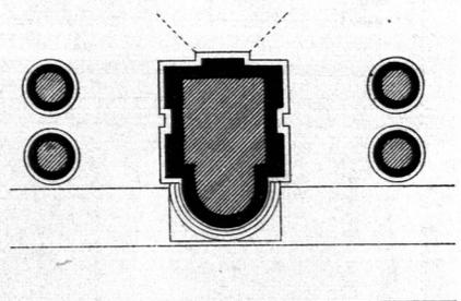
Grundriß eines Pfeilers im Erdgeschoss.
