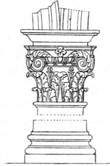
Fig. 140. Basis, Kapitell und Bogenansatz der unteren Halle<sup>70)</sup>.
